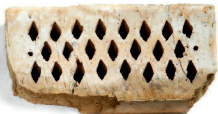
Geperforeerde baksteen met vorstschade
